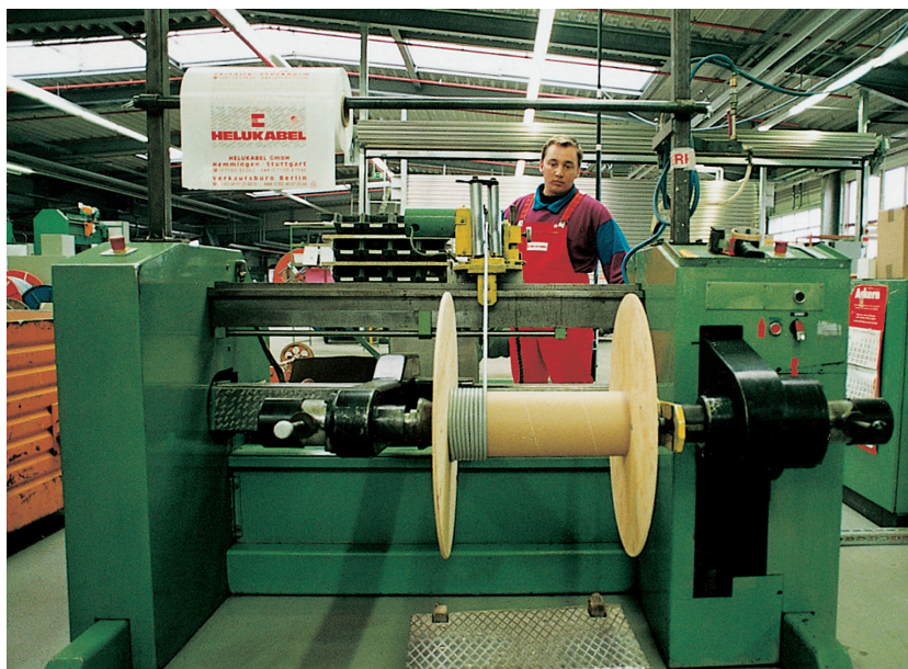
Процесс намотки на заводе Windsbach
