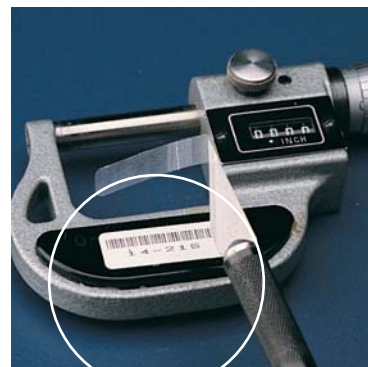
Ламинатная пленка защищает штрих-коды от загрязнений, замасливания, при этом позволяет легко их считывать.
